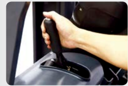
Handbremse mit integriertem Sicherheitsknopf
