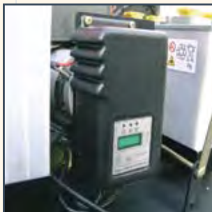
ON-BOARD BATTERY CHARGER INTEGRIERTES BATTERIELADEGERÄT INGEBOUWDE ACCUPLADER
