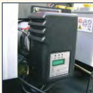
ON-BOARD BATTERY CHARGER INTEGRIERTES BATTERIELADEGERÄT INGEBOWUDE ACCUPLADER
